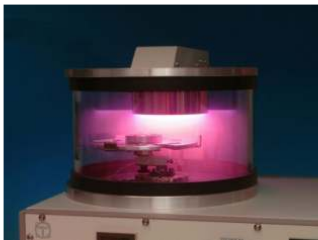
Figura 2 Plasma de argônio (Ar) Podemos utilizar diferentes gases nobres para a formação do plasma e diferenciá-los pela cor obtida.
