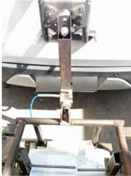
Figura 37 – Fixação da célula de carga Fonte: Lisboa; Rodrigues; Felipe (2018)
