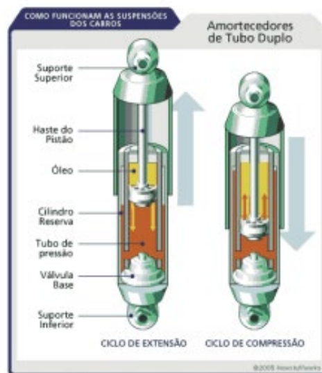
Figura 20 - Ilustração do funcionamento do amortecedor Fonte: Duarte; Barreto; Amaral (2016)
