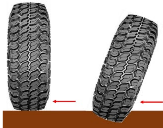
Figura 61 - Esquema representando o comportamento do pneu em terra
