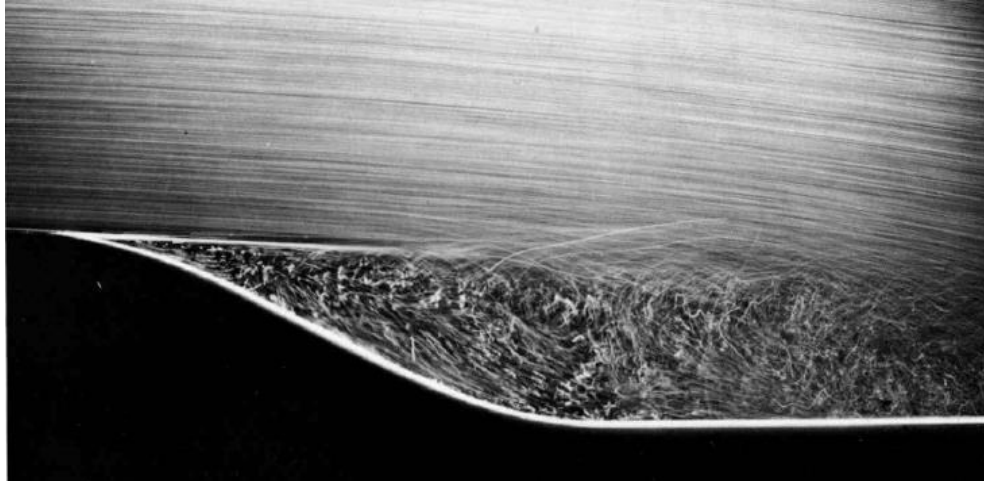
Figura 11 – Separação laminar a jusante de parede curva. Fonte: Van Dyke (1982) .
