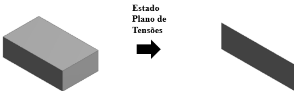
Figura 39: Premissa do estado plano de tensões utilizada no modelo. Autoria Própria.
