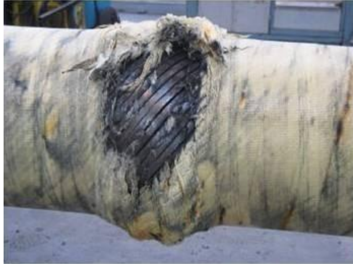
Figura 9: Efeito “gaiola de passarinho”. Modificado de [15]
