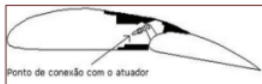
Figura 8: Asa Adaptativa (Ligas com memória de forma, 2013)
