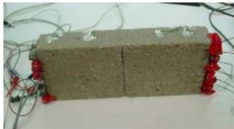
Figura 5: Concreto com fios de memória de forma (Song, 2006)
