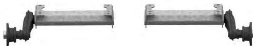
Figura 25. Semi eixo da suspensão (imagem do site da ALKO)
