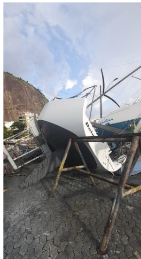
Figura 1. Acidente de tombamento de embarcações devido ao vento
