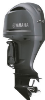
Figura 12. Motor de Popa Yamaha 250HP F250LETX 4 Tempos
