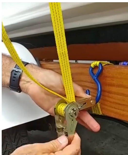
Figura 30. Demonstração da amarração da cinta no chassi
