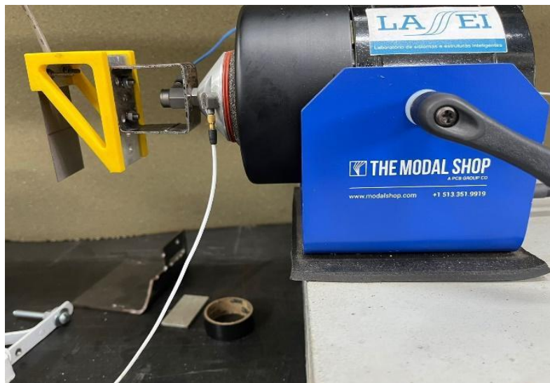
Figura 28: Placa piezoelétrica fixada no shaker modelo 2025E. Fonte: Autores.
