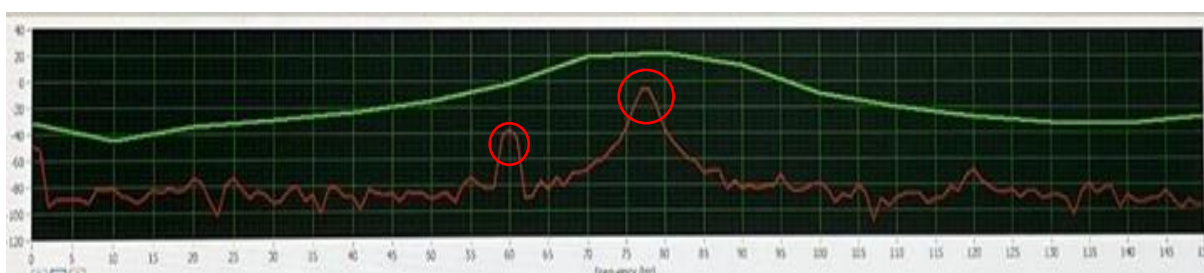
Figura 30: Resposta harmônica do piezoelétrico no Signal Express LabView. Fonte: Autores.
