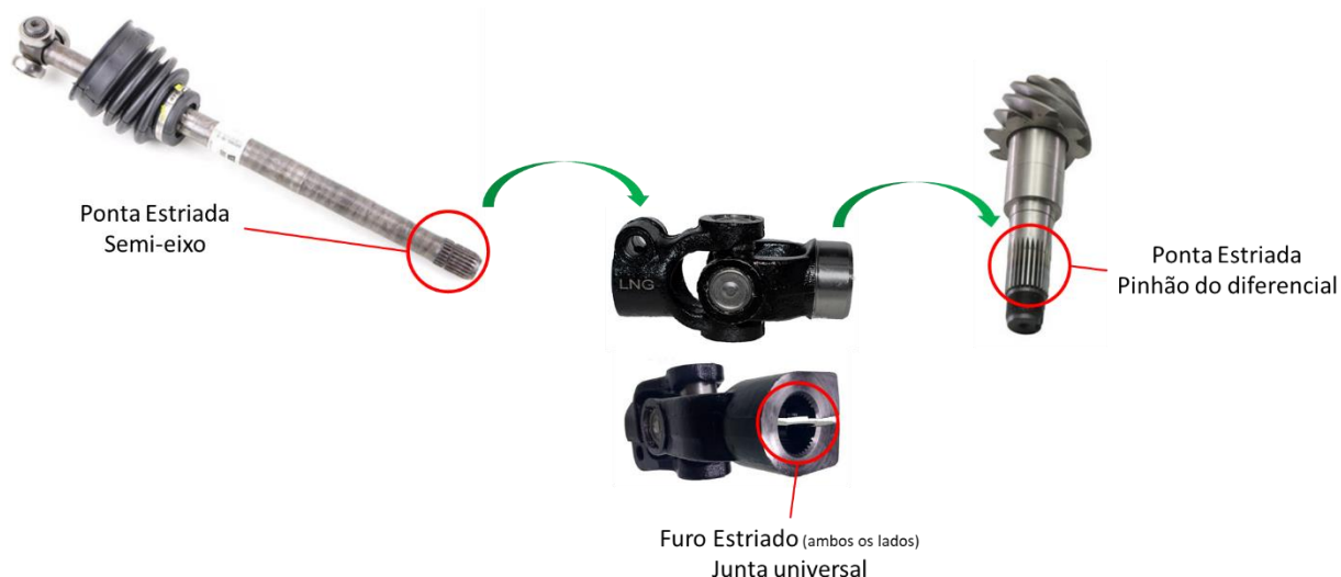
Figura 65: Detalhe estrias Cardan – Diferencial
