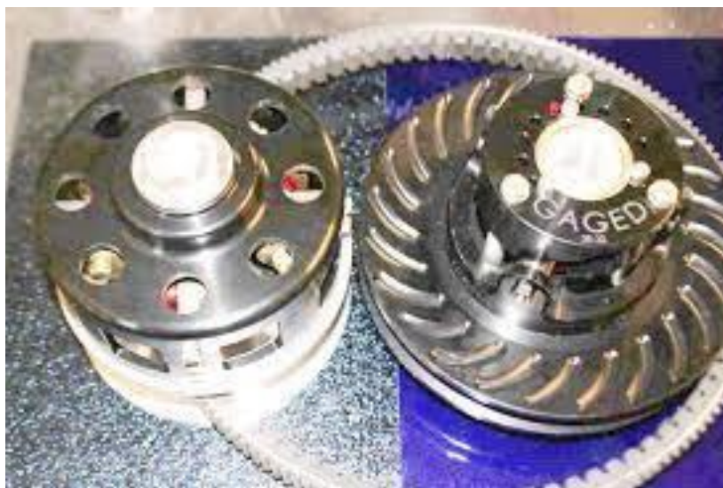
Figura 11: Modelo de CVT utilizado pela equipe (Gaged GX9)
