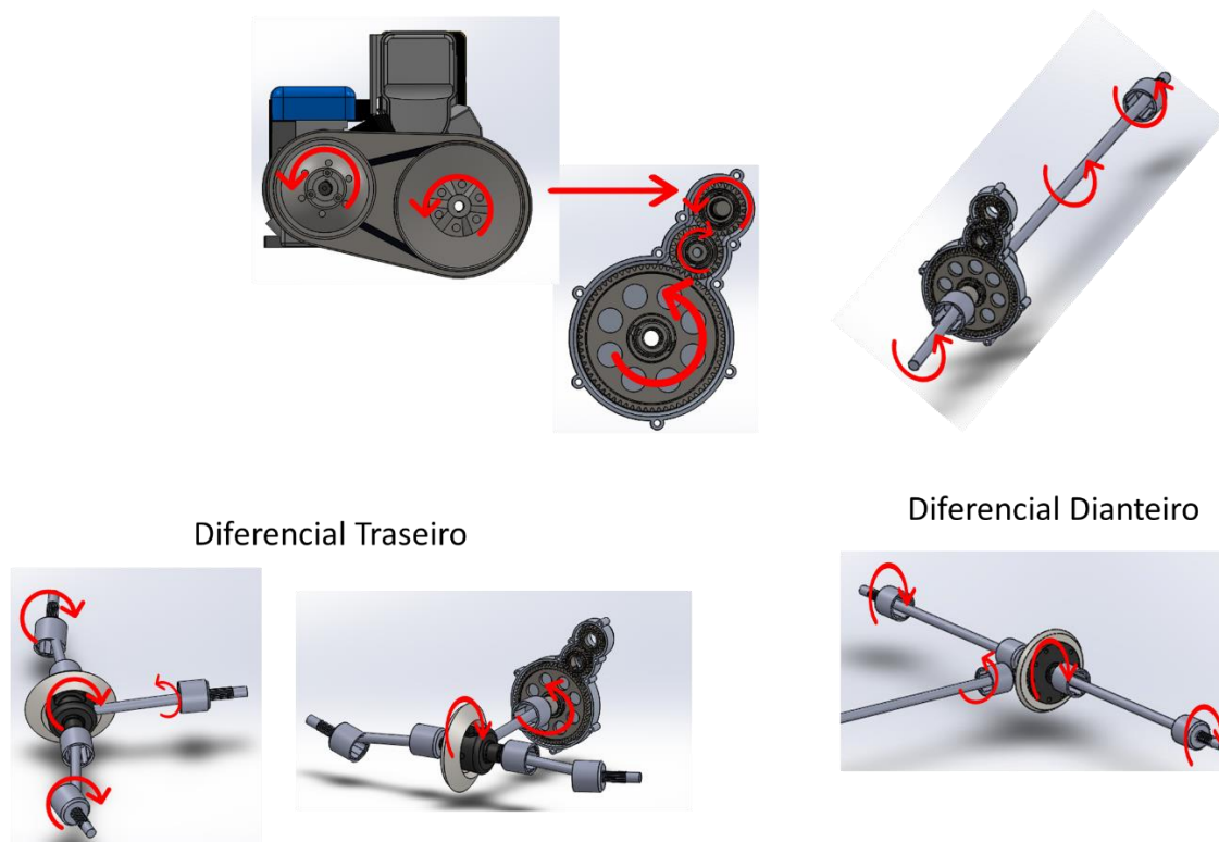
Figura 74: Fluxograma de sentidos de rotação - Transmissão 4x4
