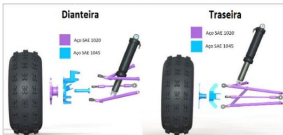
Figura 16: Modelagem da suspensão utilizada no veículo Baja atual da Mud Runner
