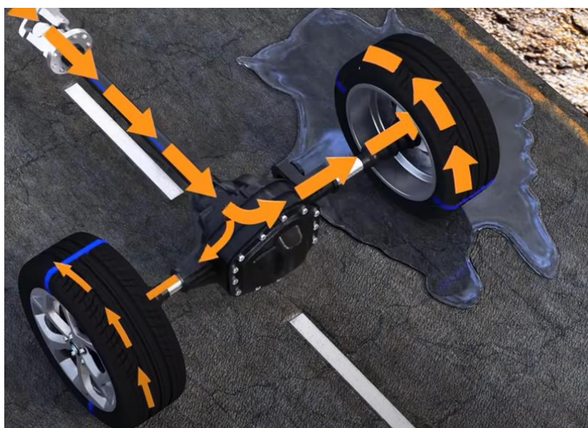
Figura 56: Esquema da distribuição de torque de um diferencial aberto em situação de perda parcial de tração.
