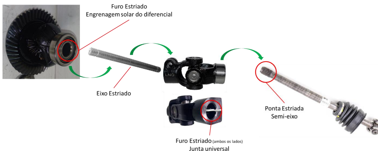
Figura 66: Detalhe Diferencial - Semi Eixo
