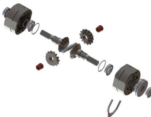
Figura 31: Visão explodida do projeto de diferencial
