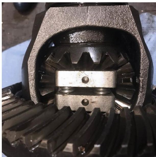
Figura 59: Placas de conversão instaladas em um diferencial
