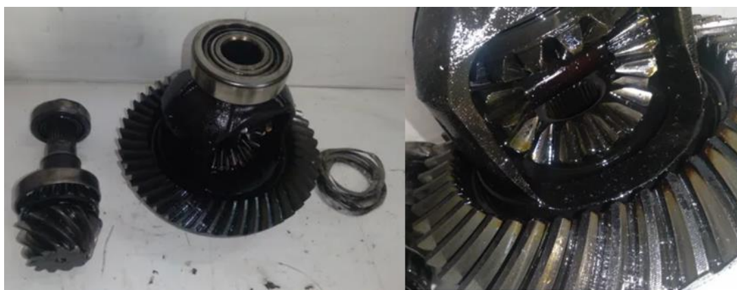
Figura 64: Diferencial de Mercedes Sprinter 310
