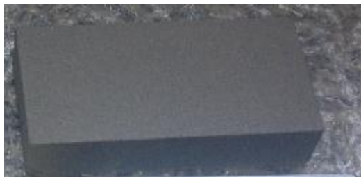
Figura 8 - Amostra jateada – Jato ao metal branco Sa 3
