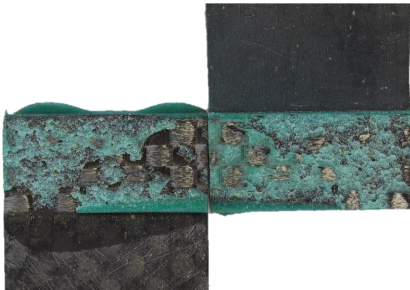
Figura 68 - Superfície de ruptura das juntas colada do CFRP - BETAMATE 2096
