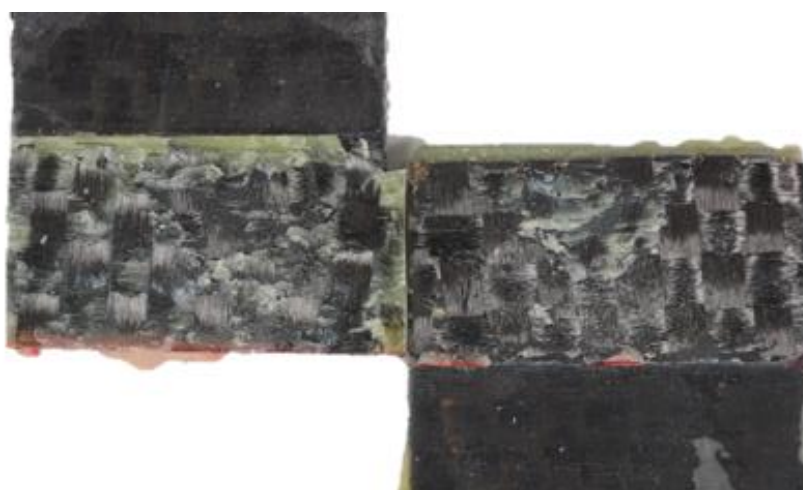
Figura 61 - Superfície de ruptura das juntas colada do AC1 - AR345
