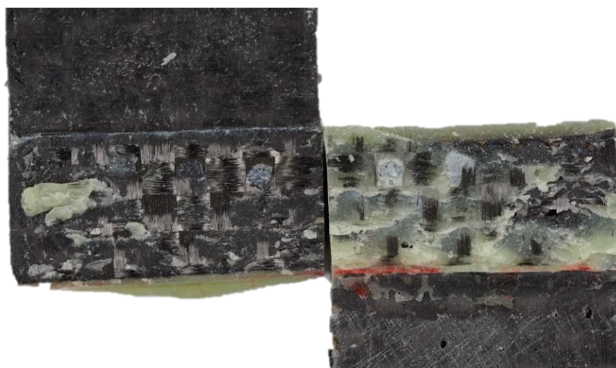
Figura 65 - Superfície de ruptura das juntas colada do C1 - AR345
