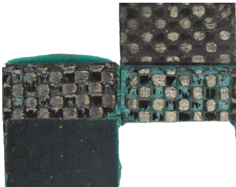
Figura 66 - Superfície de ruptura das juntas colada do C2 - BETAMATE 2096
