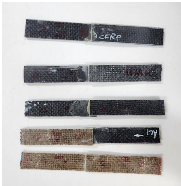
Figura 39 - Junta Colada após o processo de cura
