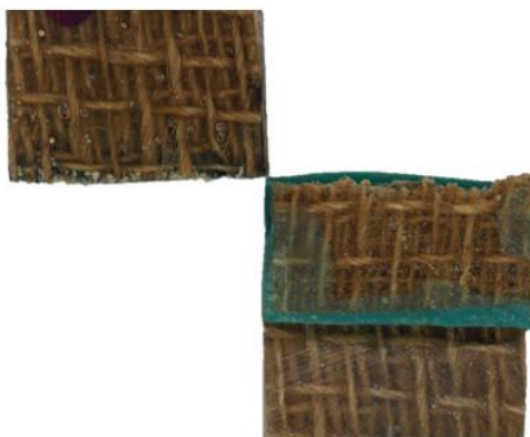
Figura 58 - Superfície de ruptura das juntas colada de JUTA - BETAMATE 2096
