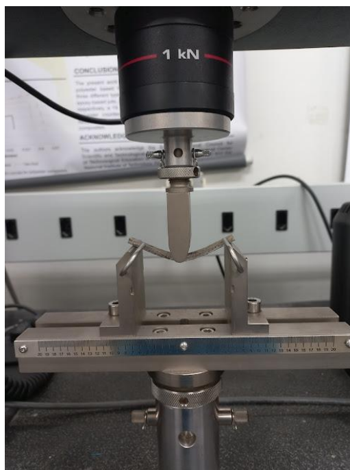
Figura 41 - Ensaio de flexão do substrato AC1
