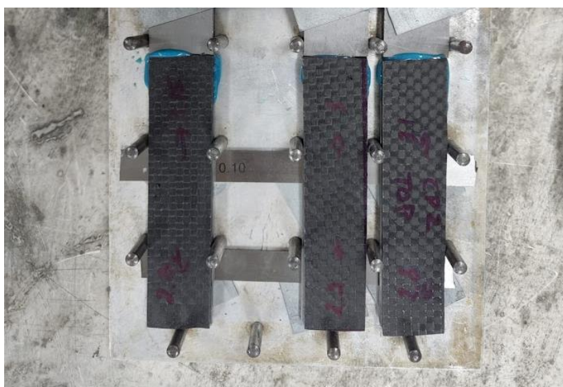
Figura 38 – Representação da Junta colada no molde após a aplicação do adesivo BETAMATE 2096
