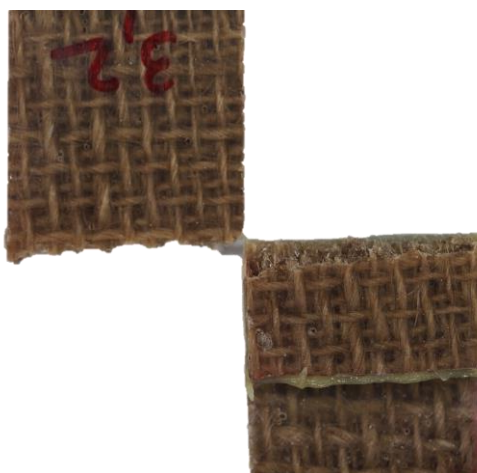
Figura 59 - Superfície de ruptura das juntas colada de JUTA - AR345
