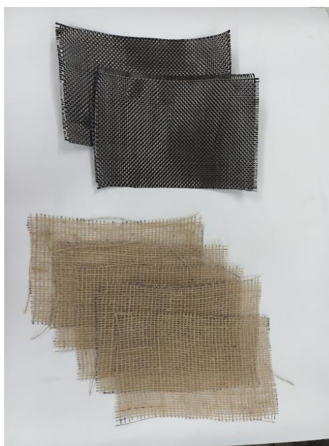
Figura 22 - Mantas de fibra sintética de carbono e fibra natural de juta
