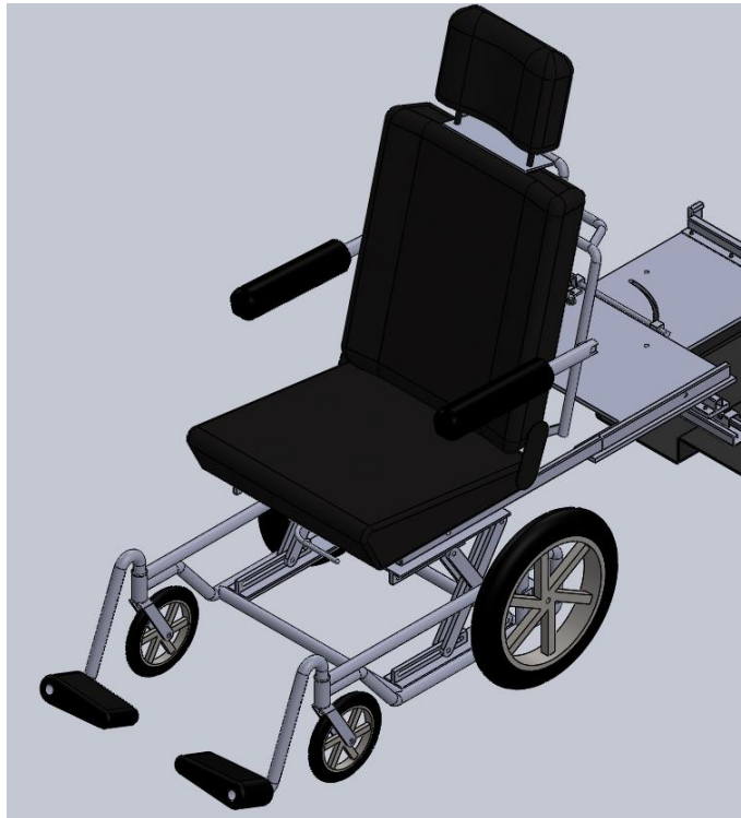
Figura 38: Transposição do banco veicular para base sobre rodas concluída
