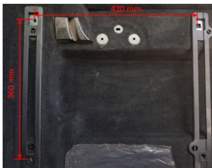
Figura 22: Posicionamento dos pontos de ancoragem no veículo.
