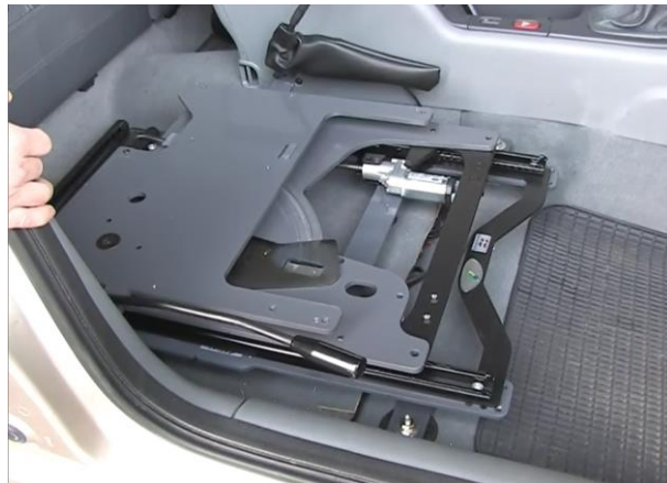
Figura 27: Plataforma de deslocamento de assento elétrico (BRAUNABILITY, 2020)
