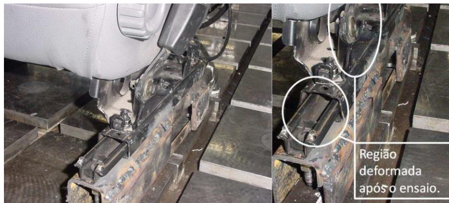
Figura 93: Deformação do sistema de deslocamento após ensaios mecânicos (LANA, 2009)
