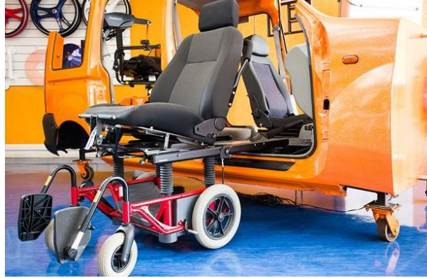
Figura 25: Cadeira de rodas adaptada ao assento veicula conecta ao mecanismo de deslocamento (AUTOESPORTE, 2016)
