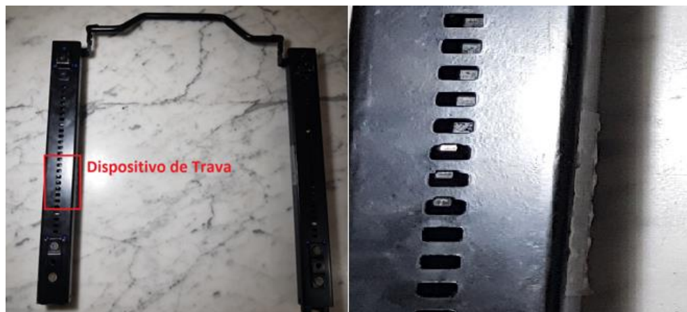
Figura 23: Sistema de deslocamento e dispositivo de trava do assento veicular original
