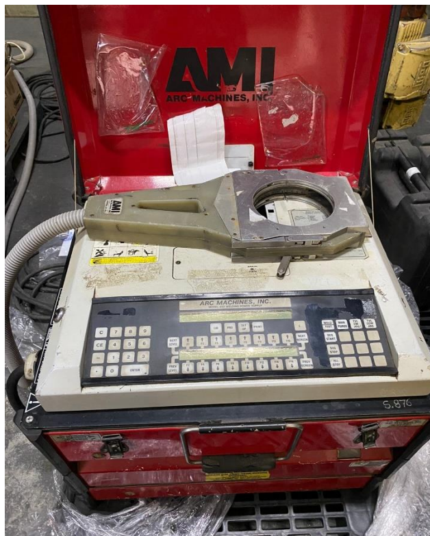
Figura 13 – Soldagem Orbital Fonte: Autores (2022)
