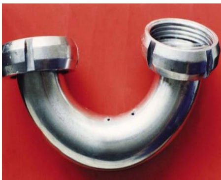
Figura 3 – Exemplo de conexão afetada pela corrosão por pites Fonte: Oliveira (2012)
