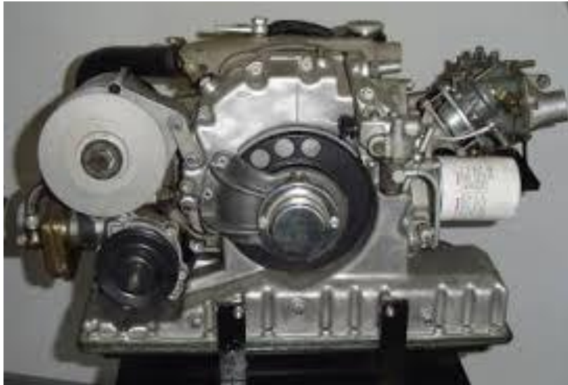
Motor Rotativo do NSU Spider (1964)
